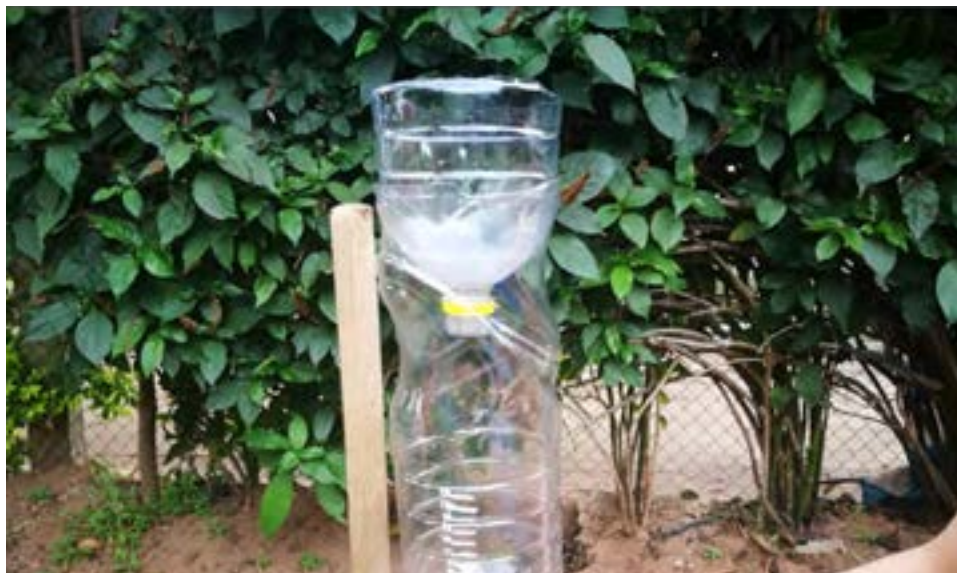
Instalación del pluviómetro. Fuente: elaboración propia
